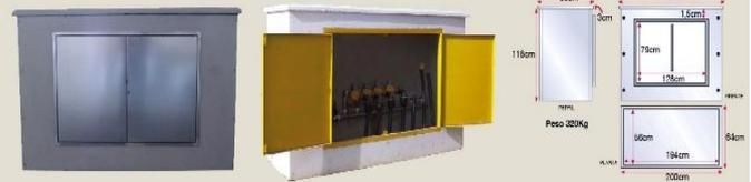
Arquetas de hormigón prefabricado para alojamiento de baterías de hasta 40 contadores en dos filas o sistemas de control de riego. Se componen de 5 placas de hormigón que se unen entre sí por medio de manguitos y tornillería especial. Puerta en chapa lacada, chapa pintada o aluminio lacado blanco y cerradura para candado. Bisagras ocultas, llave buzón y cierre antivandálico.
